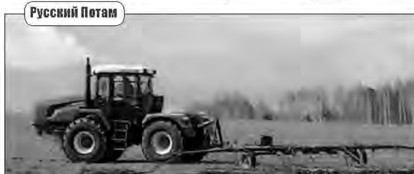
Закрытие влаги на полях с многолетними травами ИП ГКФХ Ташкинова В.В. проводилось новым трактором БЗТ — 243к со сцепной бороной БЗТС 1 — 2,4 (с. Русский Потам). Апрель 2021 года.
